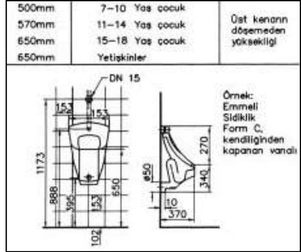
Şekil 408. PİSUAR MONTAJ YÜKSEKLİKLERİ
