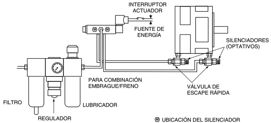
**CONTROL DE CARRETE DE SOLENOIDE SIMPLE DE 4 VÍAS - PILOTO EXTERNO - PARA OPERAR EL EMBRAGUE Y EL FRENO A PRESIONES DE 1 A 7 BARES**
