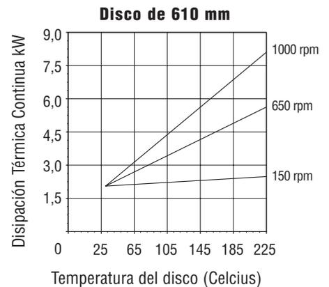
Nota: Para obtener una máxima duración de las superficies de fricción, se deberá minimizar el funcionamiento a temperaturas superiores a 233° C con superficies estándar.
