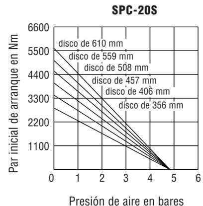
**NOTA:** Los valores de par para los frenos aplicados a resorte variarán durante la vida útil del freno en función de la fuerza del resorte y de la pasta de fricción (LOCO, STD, HICO). Durante la vida útil de las pastas, los valores de par podrán exceder los valores publicados en hasta un 40%.
