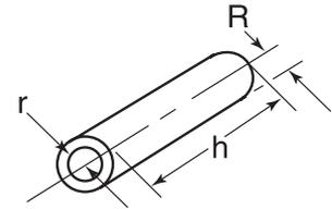
Calcule la inercia de partes complejas, concéntricas; giratorias dividiendo la parte en cilindros individuales, calculando su inercia, y sumando los valores de cada uno.
