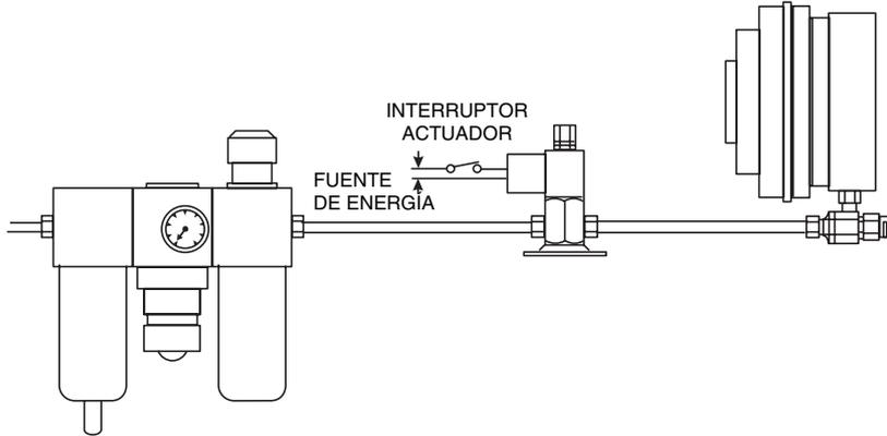
**CONTROL DOBLE CON VALVULA SOLENOIDE DE 5 VÍAS - EXTERNAMENTE PILOTADO, PARA OPERAR EL EMBRAGUE Y EL FRENO A DISTINTAS PRESIONES DE AIRE USANDO UN CONTROL - DESDE 1 A 7 BARES**
