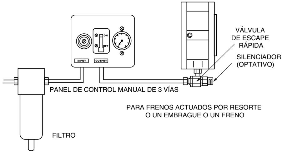
**PANEL DE CONTROL DE 3 VÍAS - NORMALMENTE ABIERTO - DESACOPLA EL EMBRAGUE O EL FRENO CUANDO EL INTERRUPTOR ACTUADOR SE CIERRA**
