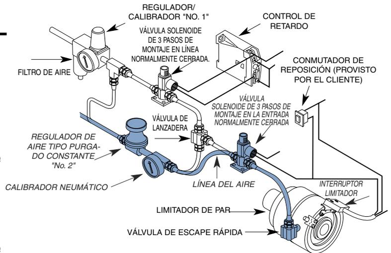
NOTA: Las letras cursivas azules y las flechas indican solamente la instalación del "sistema de presión de aire simple". El "sistema de presión de aire doble" requiere todos los componentes.
