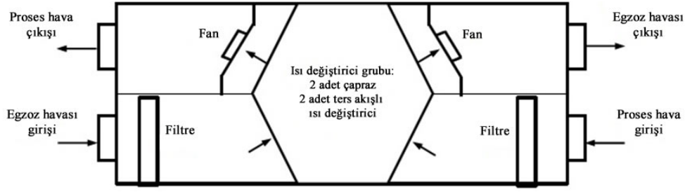
Şekil 16. Isı geri kazanımlı havalandırma cihazı ve bileşenleri [16].
