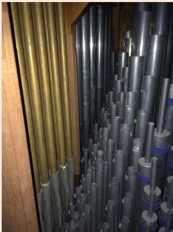
De Cornetstock van het Hoofdwerk met de onafgewerkte verlengde steunen en de met flexslang verlengde messing conducten.
