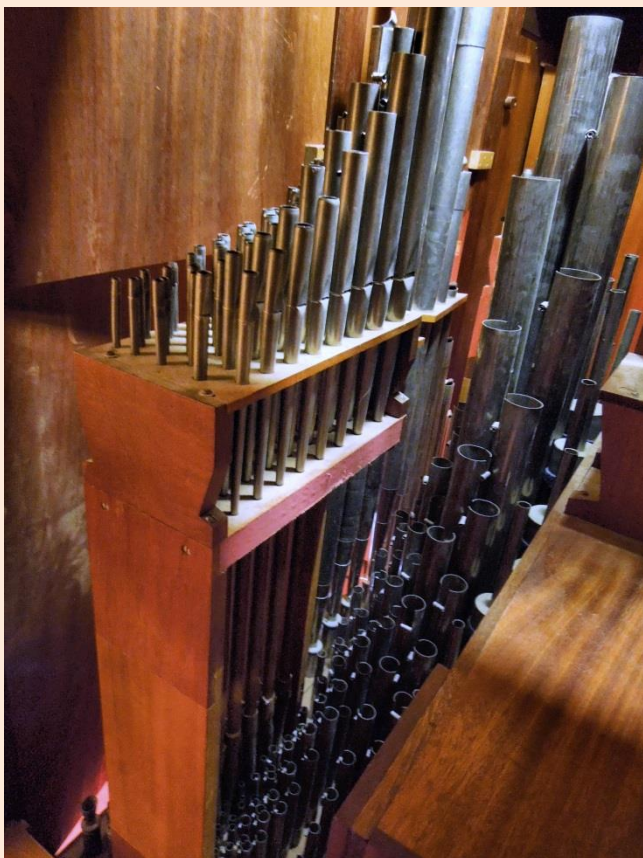
(Nevenwerk) Octaaf 2', Nasard 2 2/3', Roerfluit 4', Holpijp 8', (Hoofdwerk) Prestant 8', Roerfluit 8', Octaaf 4', Mixtuur III-IV, Cornet IV (verlengde conducten) en de Dulciaan 8' (niet zichtbaar op deze foto).
