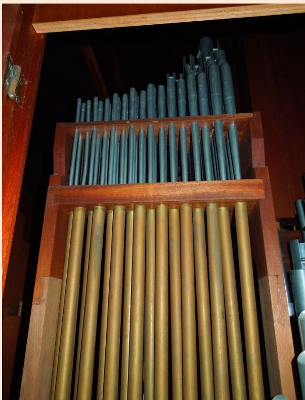
De Cornetstock van het Hoofdwerk met de onafgewerkte verlengde steunen en de met flexslang verlengde messing conducten.
