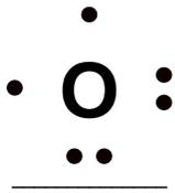
Die Lewis-Formel (Elektronenformel) ist eine chemische Strukturformel. Sie dient zur Darstellung von Atomen und Molekülen. Die Lewis-Formel ist eine Symbolschreibweise, unter Angabe der einzelnen Atome und deren Valenzelektronen.
