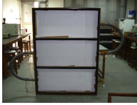
Şekil 4. Solanki vd. tarafından tasarlanmış deney düzeneğinde PV modülü monte edilmeden önce kanal geçişlerinin fotoğrafı [6].
