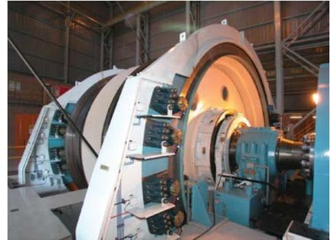
Un vez que se haya montado e instalado correctamente el sistema de frenado, es importante seguir detenidamente el procedimiento de rodaje inicial, puesto que puede tener un impacto significativo en todo el rendimiento del sistema de frenado.
