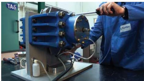
Twiflex ofrece una función «Parked Off», que elimina energía potencial del freno durante el mantenimiento y permite ajustar fácilmente la fuerza de frenado.
