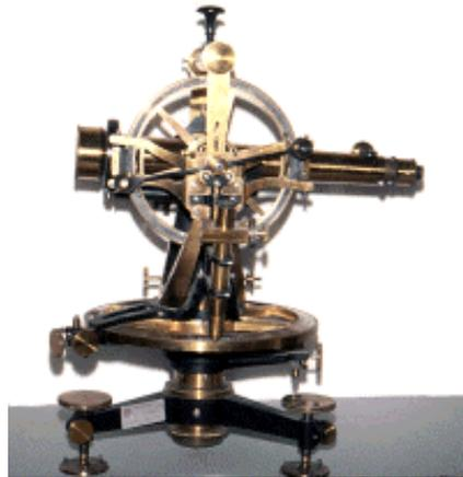
Fig. 11. Teodolito reiterador
