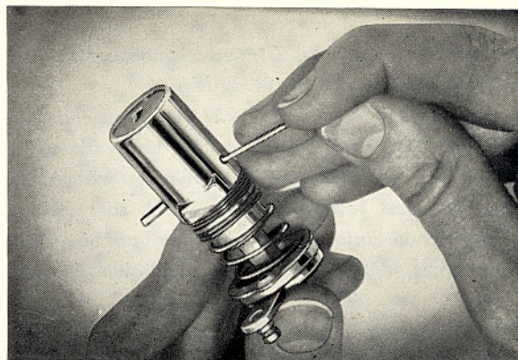
Bild 24. Låsstiftet tryckes ut
