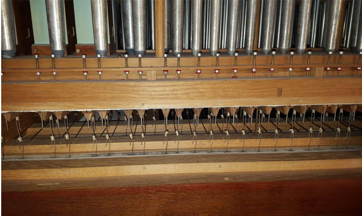
**De windladen zijn de hartstukken van ieder pijporgel. Hun kwaliteit draagt in zeer belangrijke mate mee aan de kwaliteit van het gehele instrument.** Om de juiste glans in de klank te verkrijgen is het belangrijk dat het pijpwerk wind krijgt uit tooncellen. Om deze reden zijn goede mechanische sleepladen belangrijk. De windladen in Lunteren zijn gemaakt van o.a. massief eiken en multiplex.
