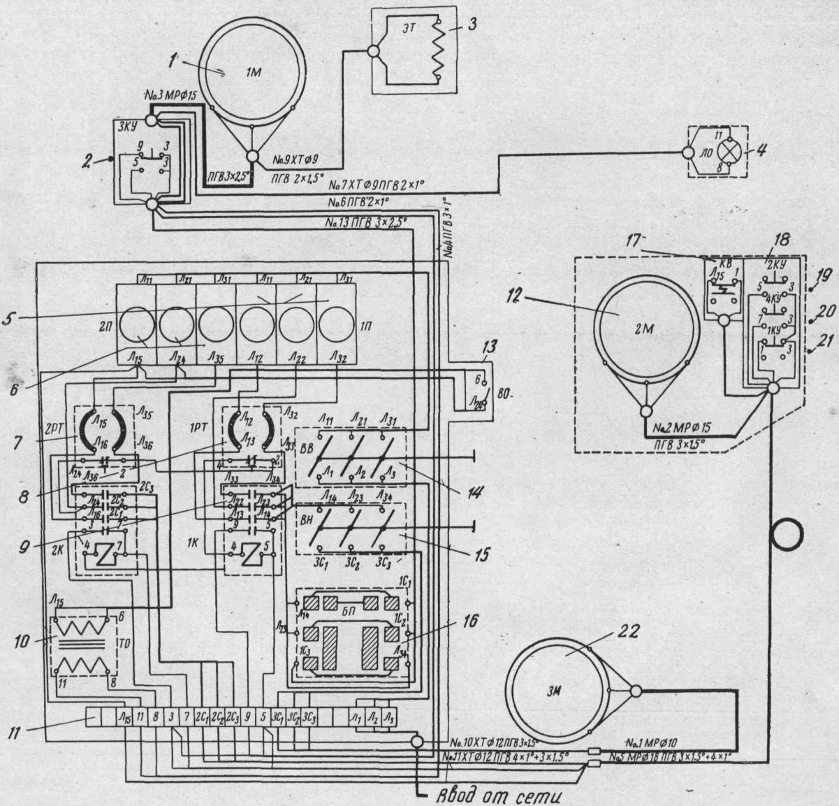
Рис. 22. Монтажная электросхема станка модели 6Н11:
