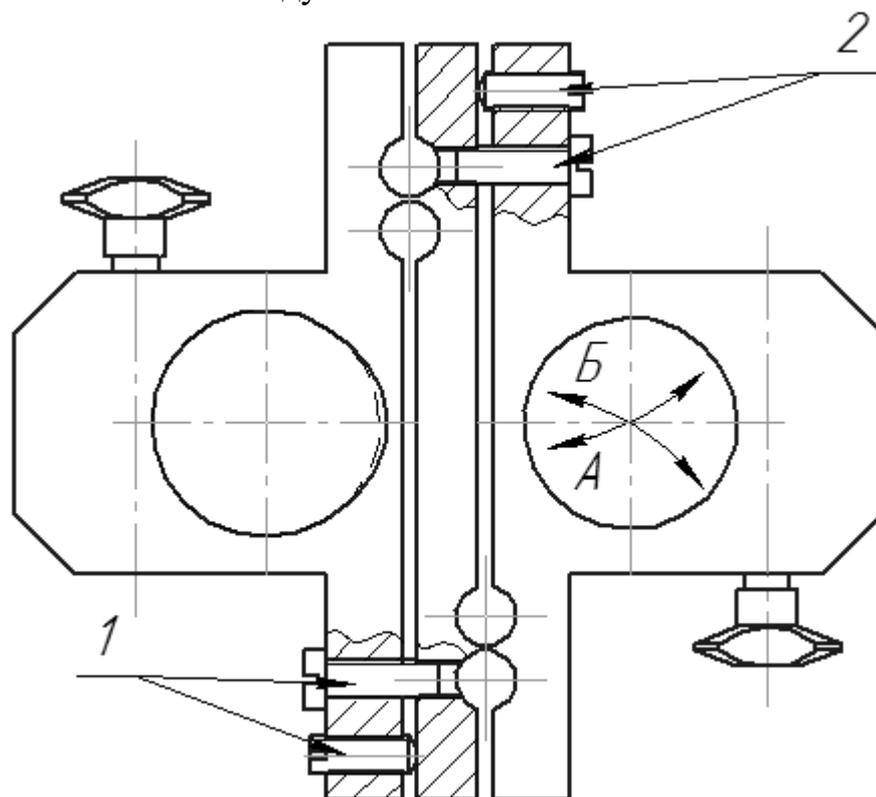
Винтами 1 обеспечивается регулировка положения измерительного наконечника по координатной оси А
