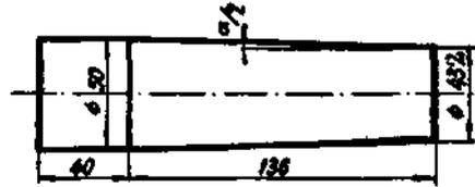
Figura 356. — Cálculo de un ángulo con interpolación.
