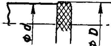
Figura 312.—  $d$ , antes de moletear;  $D$ , después de moletear.
