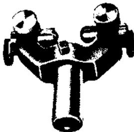
Figura 719. — Portamoletas para fijar en la torre revólver.
