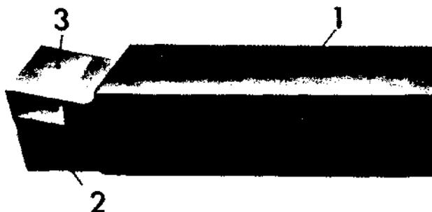
**Figura 401.** — Herramienta de carburo. 1, Cuerpo. 2, Cabeza de corte. 3, Pastilla de carburo.
