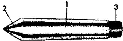
Figura 241. — Punto de torno: 1. Cuerpo del punto. 2. Cono de apoyo o superficie de referencia. 3. Cola del punto.
