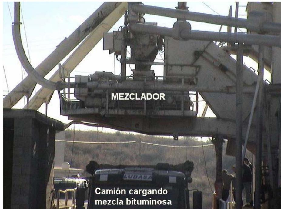
Evidentemente una planta de fabricación de mezclas en frío no dispone de ninguno de los elementos de aportación o conservación de calor indicados b, c, d, e y g.
