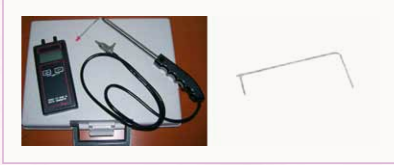
Şekil 11.3. Buhar sistemi değerlendirmesinde kullanılan pitot tüpleri (ve dijital manometre)
