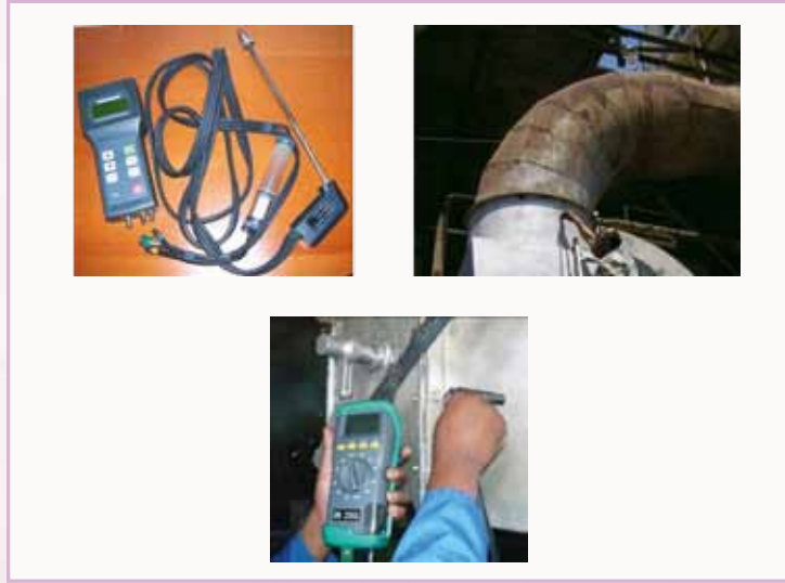
Şekil 11.4. Buhar sistemi değerlendirmesinde baca gazı analizörünün kullanılması
