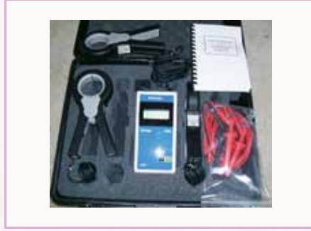
Şekil 11.5. Buhar sistemi değerlendirmesinde kullanılan taşınabilir güç ölçüm cihazı
