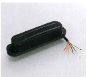
TB-1, TB-2 ¥20,000 VH-7と同様のシングルコイルサイズのハムバッカー構造でありながら、シングルコイルPUに近いトーンをローノイズで実現している。太く、つややかなサウンドが特徴で、クリーントーンにも対応する幅の広さを持つ。フロント用(TB-1)、リア用(TB-2)の2種類が用意されている。(特殊バッキング加工によりハウリング対策済み)
