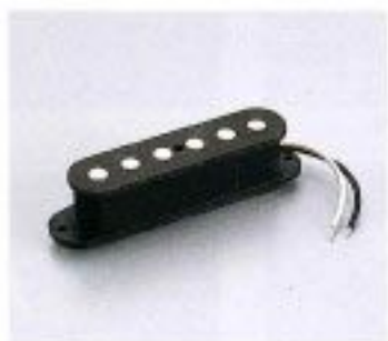
THS-1 ¥11,000 フェライトマグネットとラージポールピースの組み合わせにより、シングルPUの特性を残しながら太く、豊かな中域を実現している。ミッドレンジ用(楽器・アンプ)PUの組み合わせによりLow、Midの程よくカットされたTHSならではのハーフトーンが得られる。(特殊バッキング加工によりハウリング対策済み)
