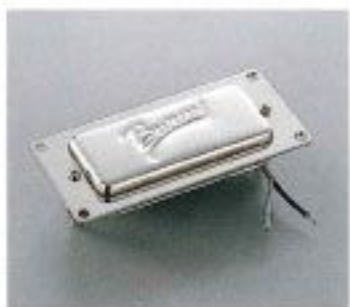
GMH-220 ¥12,000 Bummyシリーズ用に専用設計されたモデル。カバード・タイプでありながら優れたパーフェクト・ボイントをピックアップすることができ、コイル・ターン数を少なめに設計することにより、音のほろりとしたサウンドを得られる。またGMHシリーズは特殊構造によるセーリング効果を生じており、ハウリングに圧倒的に強いのが特徴。
