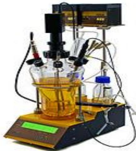
**Gambar 1.3** Fermentor/bioreaktor skala laboratorium (sumber: [https://id.wikipedia.org/wiki/Berkas:Autoclavable\\_bench-top\\_laboratory\\_bioreactor](https://id.wikipedia.org/wiki/Berkas:Autoclavable_bench-top_laboratory_bioreactor))
