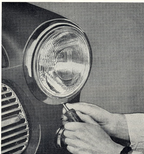
Bild 113. Demontering av strålkastarsarg
