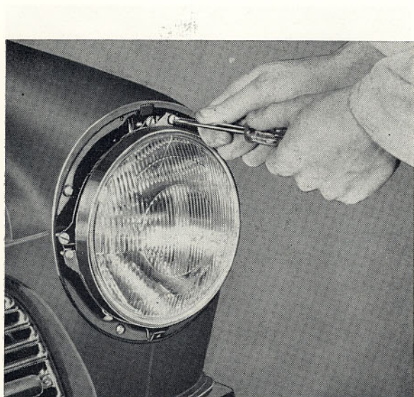
Bild 114. Demontering av hållring
