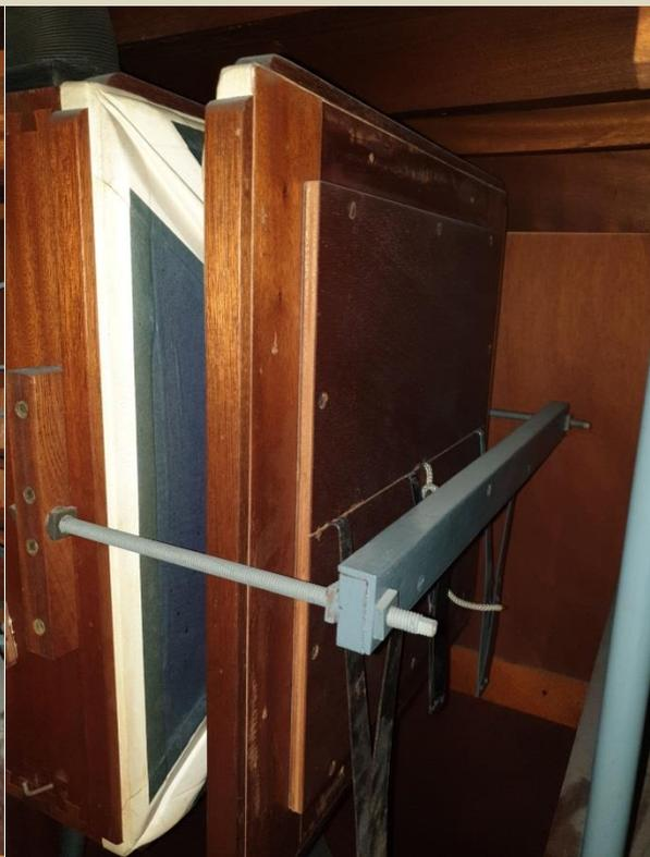
De windvoorziening van het orgel staat in de orgelkas onder de manuaalwindladen. Ze bestaat uit een ventilator (380VAC) in een geïsoleerde kist, een windreguleerkast en meerdere traditioneel vervaardigde vouwbalgen en z.g. stootbalgen waarvan de windkanalen van flex en pvc naar de windladen-kleppenkasten lopen. Het schapenleder is origineel.
