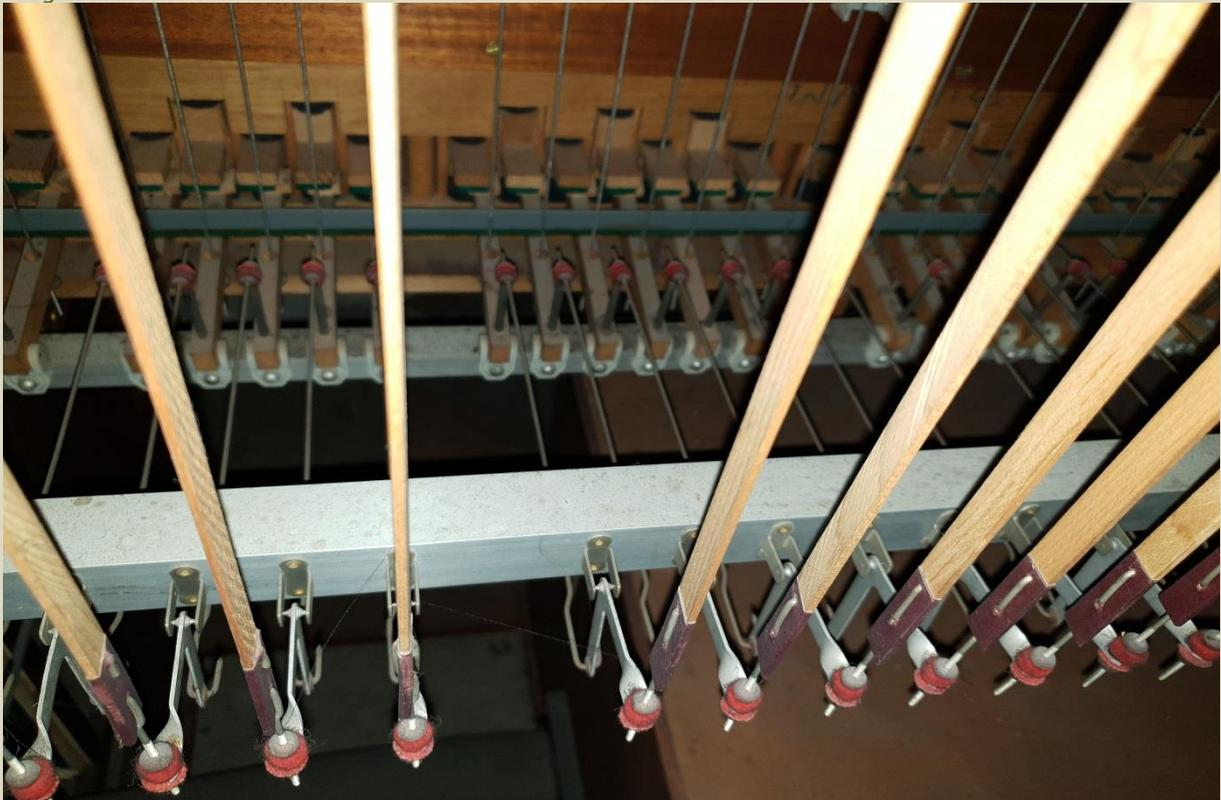
De registertraktuur is mechanisch en bestaat uit hout en metaal. De registerknoppen zijn verdeeld aan beide kanten van de speeltafel en zijn gemaakt van hout, de registertrekkers van eikenhout en de balansen van ijzer dat geverfd is om roestvorming tegen te gaan.
