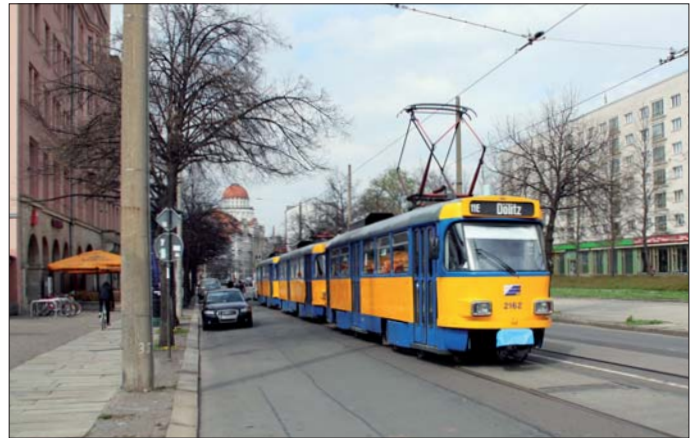
Ein Tatrazug der Linie 11E, bestehend aus drei Triebwagen T4D, fährt zwischen Hohe Straße und Süßplatz auf Höhe Shakespearestraße in Richtung Dölitz. Hier ist reichlich Platz für einen eigenen Gleiskörper vorhanden, der bald die heute dort notwendige Schleichfahrt mit maximal 10 km/h ersetzen wird...
