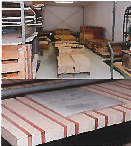
保管室（シーズニング・ルーム）内全景（上）。中央はボディ材、左の棚にはネック材が置かれていた。下はメイプルとブビンガのラミネート・ネック材。
