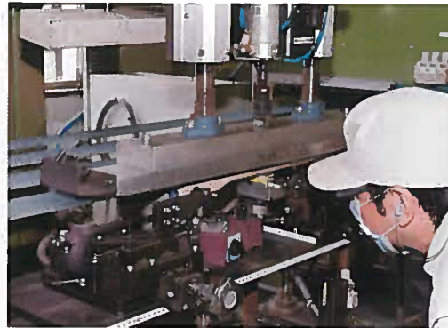
こちらは指板面にベルト・サンダーをかけているところ。ブルーのヤスリは上部を一周するようになっていて、高速で回転しながら指板面を削る仕組みとなっている。ヤスリは4種類あって、だんだん細かい目になっていく。この作業をすることで良いネックがわかるのだという。トラスロッドが効いた状態で厚みと左右が均一ならば良いネックというわけ。
