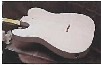
NCTLのボディにホワイト系のラッカー塗装を施したところ。木目が美しく浮き出る薄いつまみ仕上げはさすが「神」の仕事。
