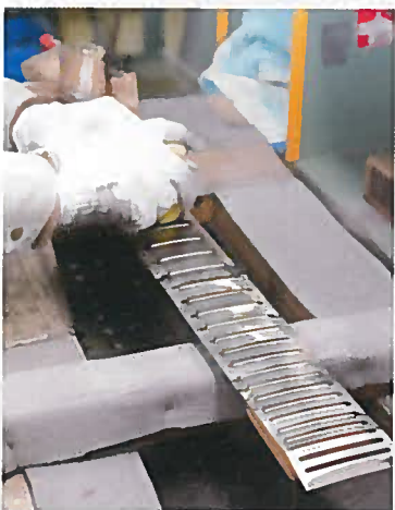
フレットのすり合わせ作業。フジゲンではネックの作り込みの精度が非常に高いため、ここでの作業は調整的なものとなる。メイプル・ネックは塗料が乗っているため、スリットで指板を保護しながら行なう。
