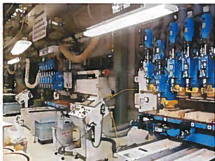
フジゲンでは5機の大型NCルーターを稼働させている。1台につき一回3本分のボディの削り出しが可能だ。
