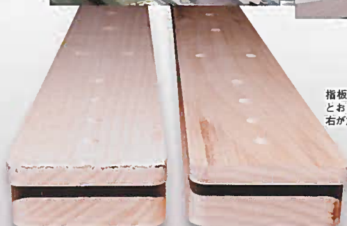
ストラト・タイプのネック加工。奥が加工前で手前が加工後だ。ヘッドのしゃくりと呼ばれる部分、トラスロッド調整口周辺の角度がなめらかになっているのわかる。
