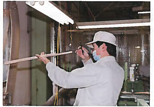
トラスロッドを入れてネックの状態を入念にチェック。これはベテランの経験がものを言う作業である。
