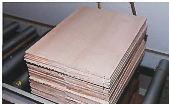
写真はマホガニー材。ここからEFL(レス・ボール・タイプ)2本分のネックを切り出す。
