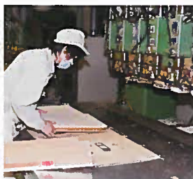
トップ材とバック材を貼り合わせ、治具に載せてNCルーターへ。
