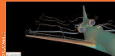
Simulation aérodynamique d'un avion Falcon en 3D.
