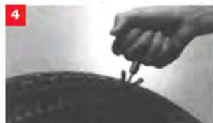
4 SPINGERE LA STRINGA NELLA GOMMA SUPERANDO LO SPESSORE DEL PNEUMATICO
