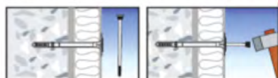
Inserire il tassello di Nylon finché la rondella non aderisce al pannello Inserire a martello il chiodo fino a espansione ultimata
