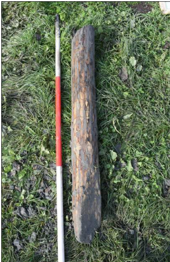
Afb. 40. Twee van de funderingspalen (S64).
