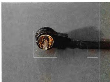
*Fernstartkabel. Für diesen Stecker bietet der Visacoustic eine Buchse. Zum Anschluß des Tonbandgeräts gibt es das IAW-Adapterset.*
