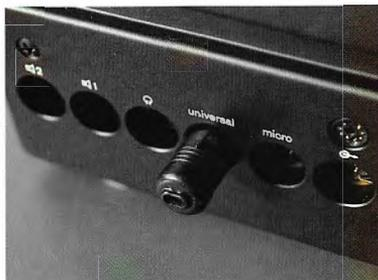
*Multiplay. Zur absolut synchronen Spur-zu-Spur-Überspielung brauchen Sie nur diesen Stecker in die Universalbuchse zu stecken.*
