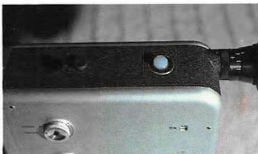
Bei meiner Nizo 560 gelangen mir die automatischen Überblendungen nicht immer ohne Verwackeln. Nachdem auf dem Auslöseknopf ein Zusatz mit Zwei-Komponenten-Kleber angebracht wurde, der wie die Brennweitentasten aus dem Gehäuse ragt (Abbildung), geht es ohne Wackeln. Mit dem Daumen wird unter dem Gehäuse gegengehalten, und das Auslösen kann jetzt, statt mit der Fingerkuppe, mit dem flach aufgelegten Finger erfolgen. Das geht auch auf dem Stativ sehr gut.
