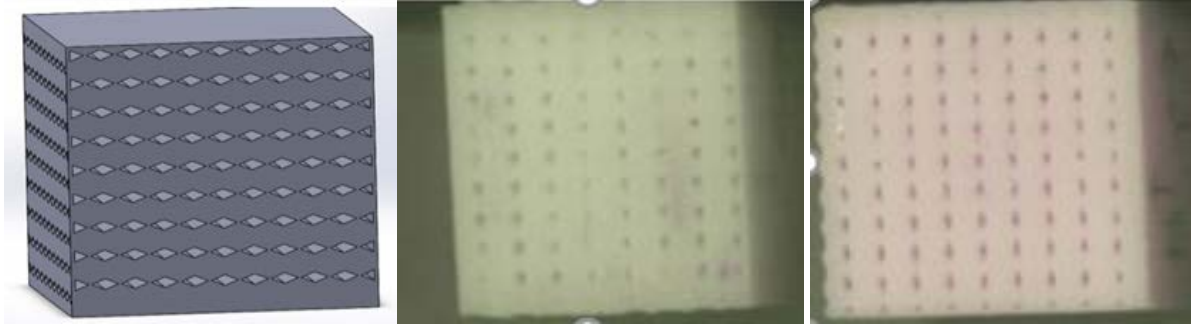
Şekil 7. 800 µm kanal aralıklı tasarım ve 90 µm ile 260 µm katman kalınlıklı baskı denemeleri
