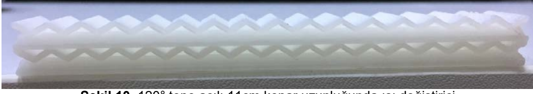
Şekil 10. 120° tepe açılı 11cm kenar uzunluğunda ısı değıştirici
