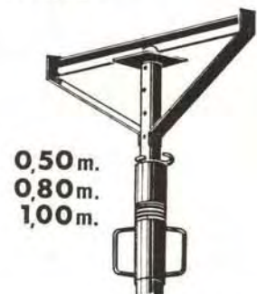
⑪ Coffrage à 1 file d'étais porteurs de consoles métalliques
