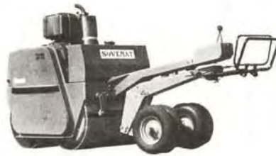
②④ Rouleau vibrant tandem hydrostatique
