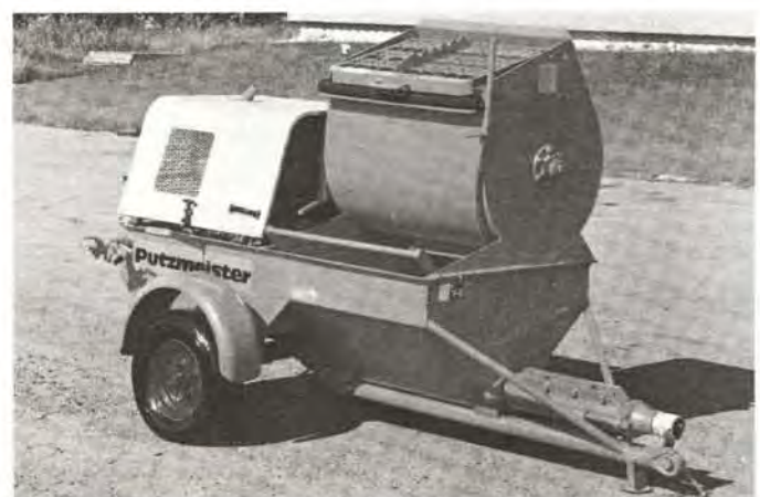
⑧ Machine à projeter les mortiers
