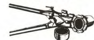
Coupe tuyau à chaîne manuel ou hydraulique
