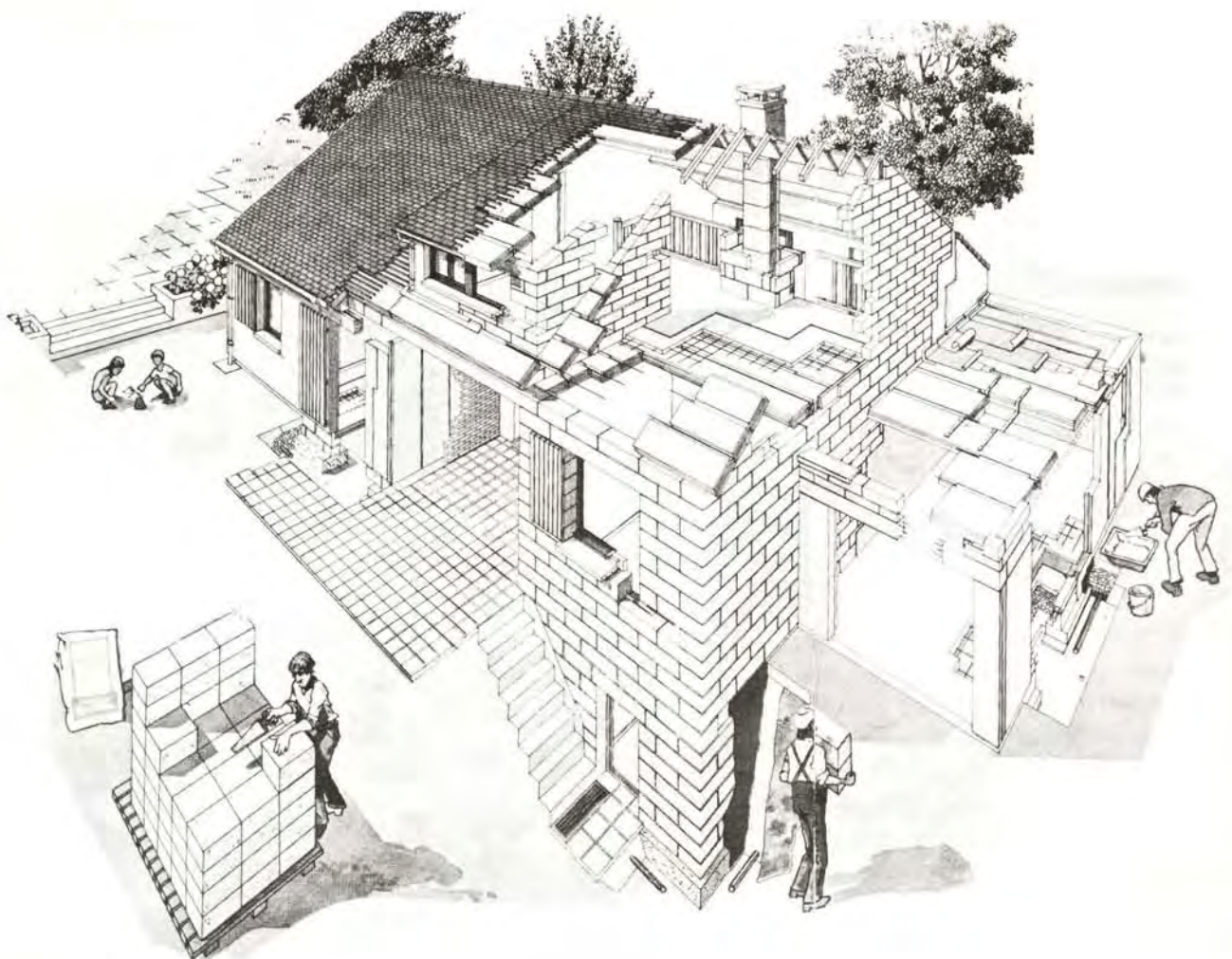
VUE D'ENSEMBLE : CONSTRUCTION D'UN PAVILLON EN BÉTON CELLULAIRE
