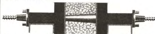
⑤ Boulon traversant et entretoise cônica
