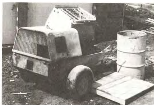
② b Malaxeur avec pompe à mortier
