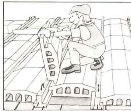
⑥ Entrevous en polystyrène expansé
