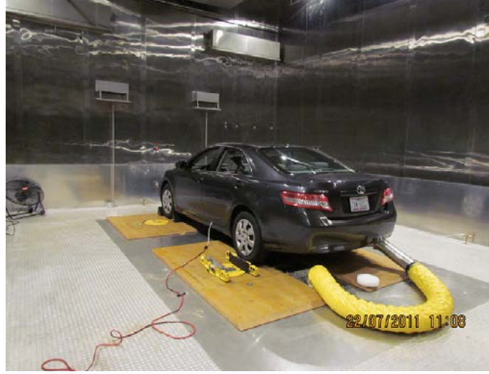
Şekil 2. İklimlendirme odasına yerleştirilmiş deney arabası [18].
