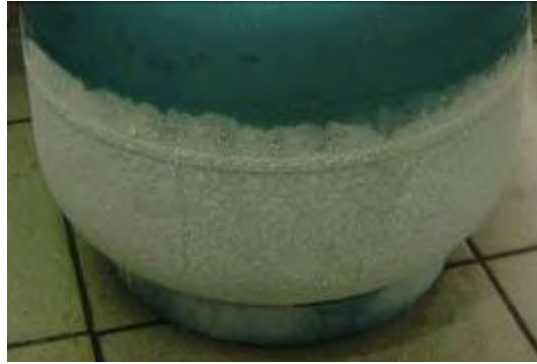
Tüpün soğuması sonucu yüzeyinde meydana gelen değişim
