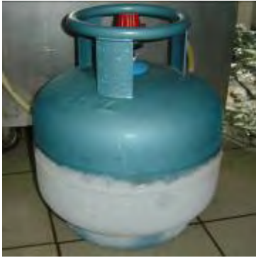
Tüpün soğuması sonucu yüzeyinde meydana gelen değişim
