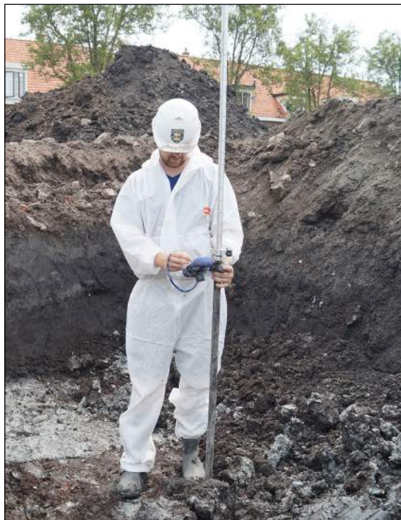
Afb. 3.3. Vlakken met weinig muur- of houtresten werden digitaal ingemeten met een Robotic Total Station (RTS).
