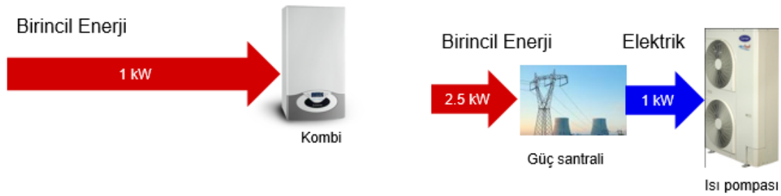
Şekil 1. Kullanılan birincil enerji kaynaklarına göre iklimlendirme cihazları arasındaki ilişki
