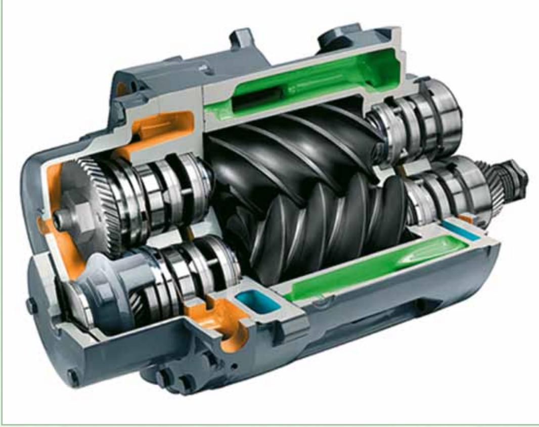
Şekil 3.4. Yağsız dönel vidalı kompresör hava kafası (Atlas Copco'nun izniyle)
