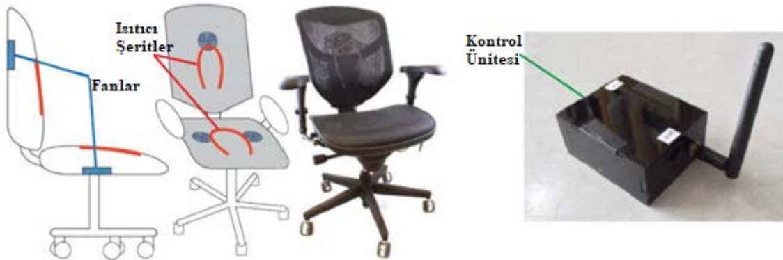
Şekil 6. Kişisel ısıl konfor sistemleri içeren ofis koltuğu, bu koltuktaki ısıtıcı şeritler ve fanların kontrol edilmesinde kullanılan kontrol ünitesi [27].
