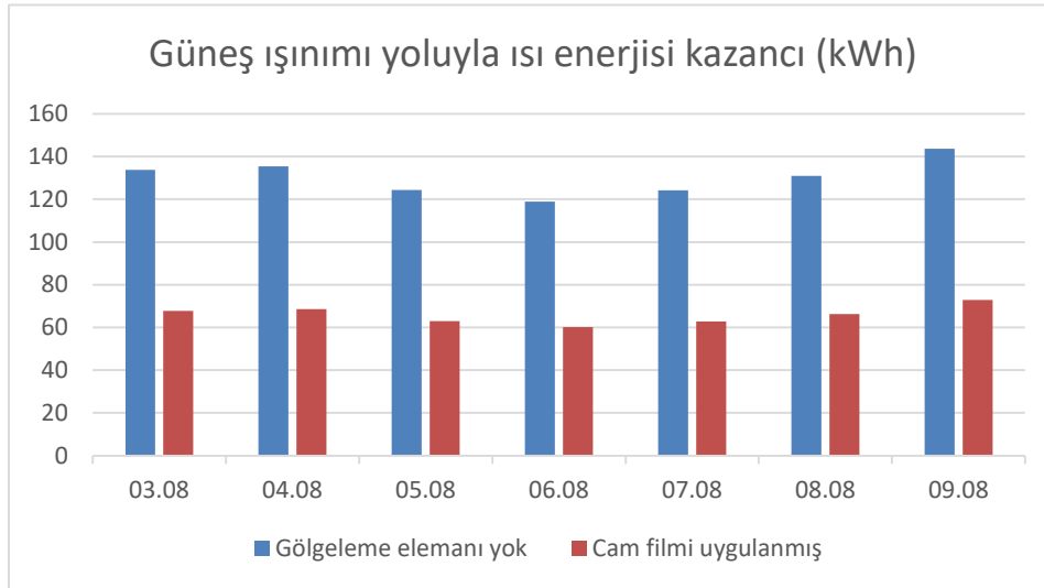
Şekil 6. Cam filminin güneş enerjisi kazancına etkisi.
