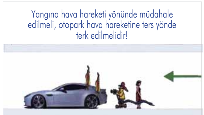
Şekil 5- Geri akış (ceiling jet) kontrolü
