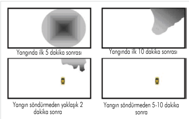
Şekil 13- Yangın dumanının akış kontrolü yönteminin zamansal analizi
