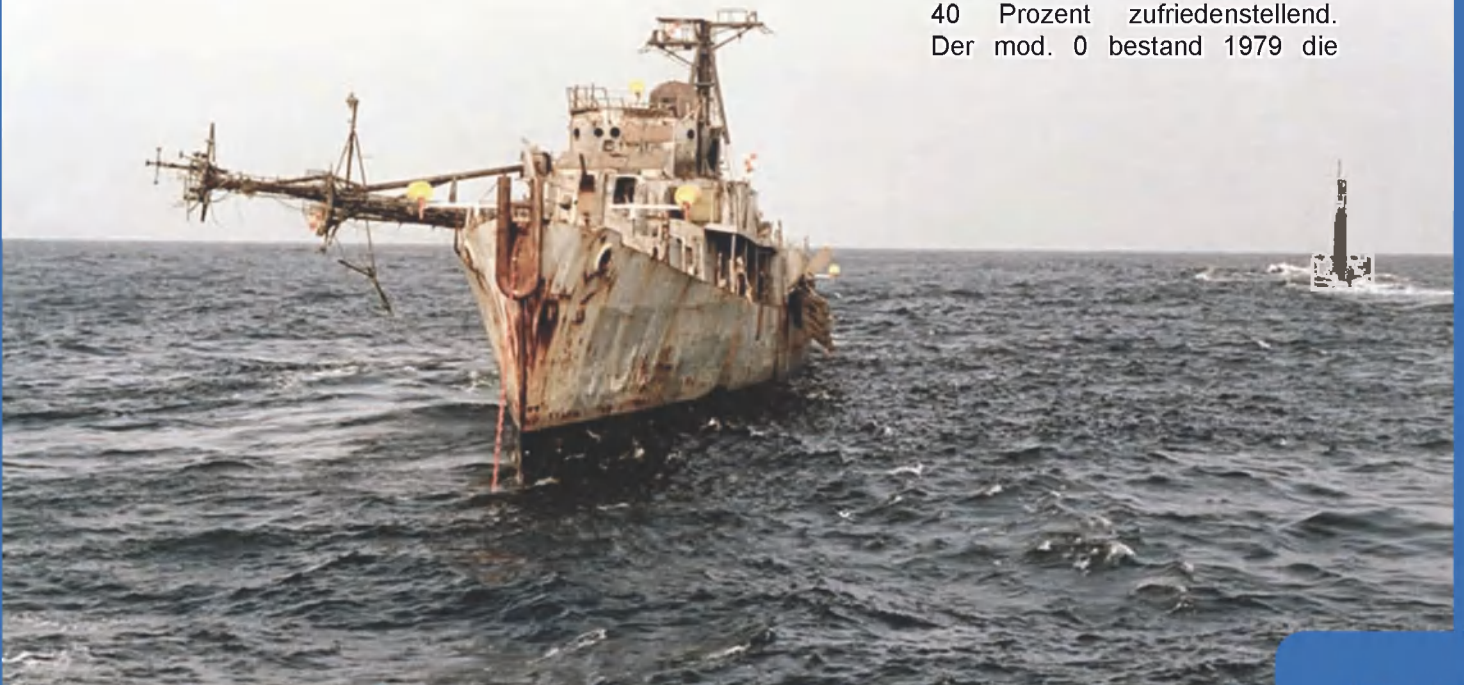
Der Zerstörer Ex-USS HISSEM nach einem Angriff mit mehreren Flugkörpern des Typs Sub Harpoon. Rechts im Bild die auftauchende HMS COURAGEOUS Quelle: US Department of Defense
