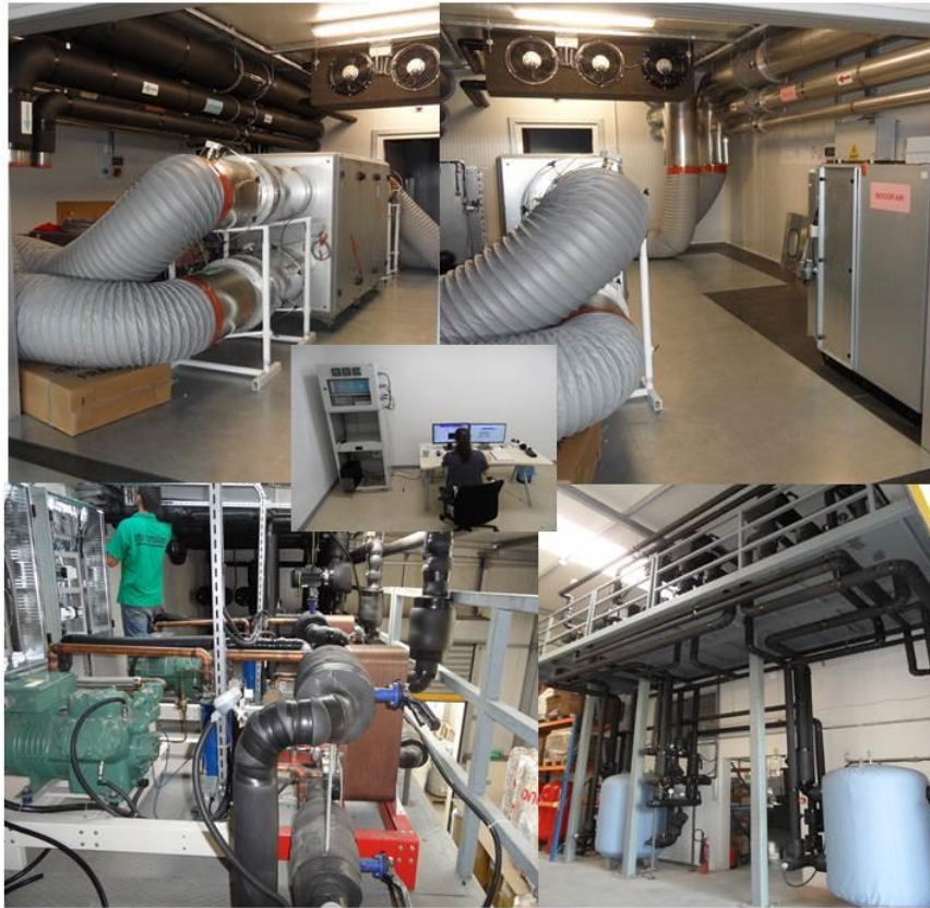
Şekil 14. TS EN 308 Sıcaklık Verimi test laboratuvarı.
