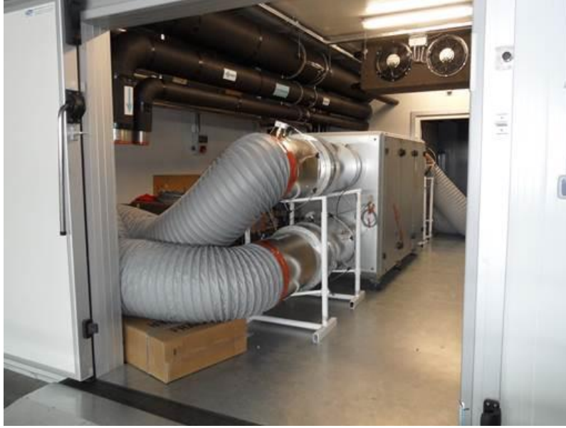
Şekil 25. 2000 m 3 /h nominal debiye sahip bir IGKH cihazının performans testi.
