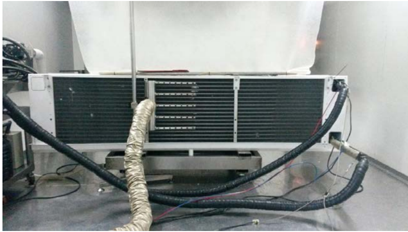
Şekil 9 Test cihazının kalorimetrik odaya yerleşimi
