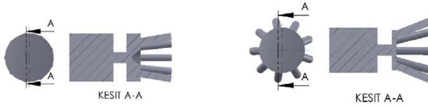
Şekil 11 Dağıtıcıların A-A kesit görünümü
