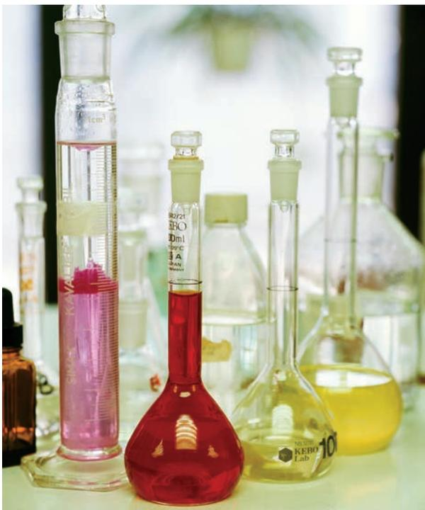
Material para medir volúmenes en el laboratorio: probeta y matraces.
