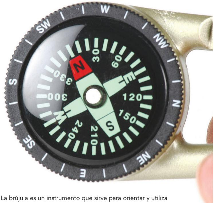
La brújula es un instrumento que sirve para orientar y utiliza el magnetismo para su funcionamiento. La aguja siempre señala el norte magnético de la Tierra.
