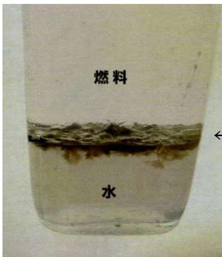
と共に微生物はスライム（ヘドロ状物質）又は「バイオマス（有機性物質）」を生成し、こうして生じた界面活性物質の力をも借りて、タンクあるいは装置の中身がかき乱されたりすると、直ちに燃料相（あるいはオイル相）内に拡がって行きます。更に、微生物によるバイオマスは「バイオフィルム（生物膜）」となってタンク壁面に付着し、タンクの塗装やプライマーの劣化を
