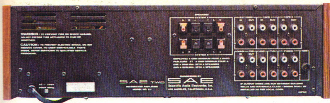
La fotografia del pannello posteriore mette in evidenza il vasto assortimento di prese ed i comodi morsetti per il collegamento dei diffusori. Alcune fessure orizzontali migliorano il raffreddamento del trasformatore di alimentazione.
