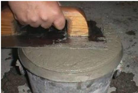
*Fabricación de probetas (ø15cmx30cm)*
