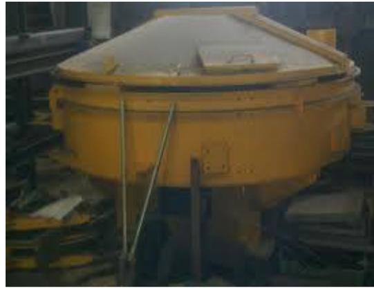
*Amasadora de hormigón de eje vertical*
