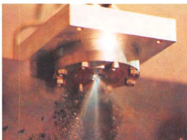
Zu den Abbildungen: Oben Testlauf des Triebwerks LM 100. Unten Einspritzversuch mit gefärbten Flüssigkeiten. Fotos WARR
