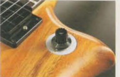
スタンバイ付ロータリーPUセレクター
