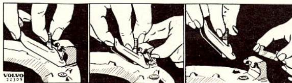
Bild 11. Demontering av hävarmar.
