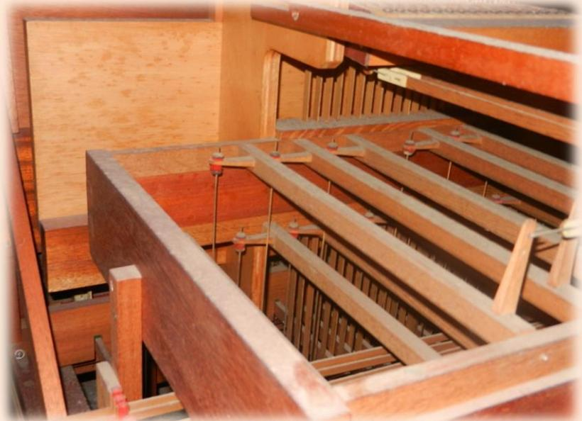
**De toetstraktuur** is op ambachtelijke wijze vervaardigd met houten walsen en ramen, abstracten en fosforbrons en messing vertint draadwerk. De moeren zijn van leder met kernlaken en vilt, de invoeringen zijn van kernlaken.
