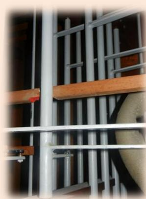
**De mechanische registertraktuur** bestaat uit metalen walsen en balansarmen of z.g. zwaarden. De verbindingstrekkers zijn van hout. Alles is zeer degelijk gemaakt, de armen zijn vast gelast op de walsen zodat er tijdens het gebruik nooit iets kan losgaan of verschuiven.
