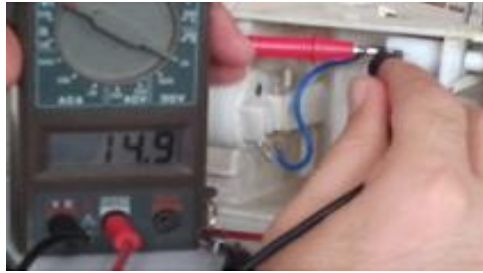
Resim 5.2: Aydınlatma lambası elektrik bağlantı kontrolü
