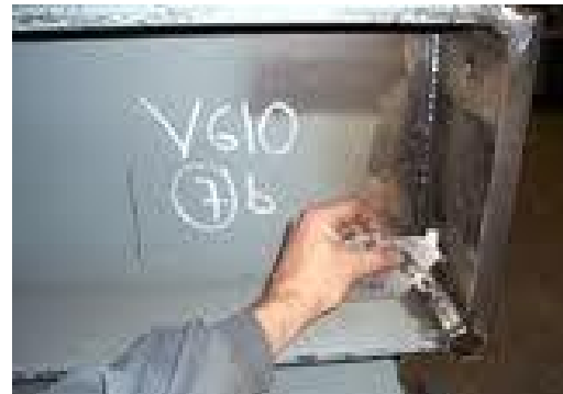
Medición de garganta del cordón en ángulo
