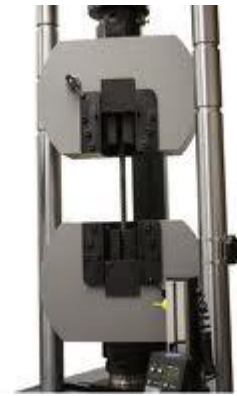
Ensayo para medir la tensión "σ"
