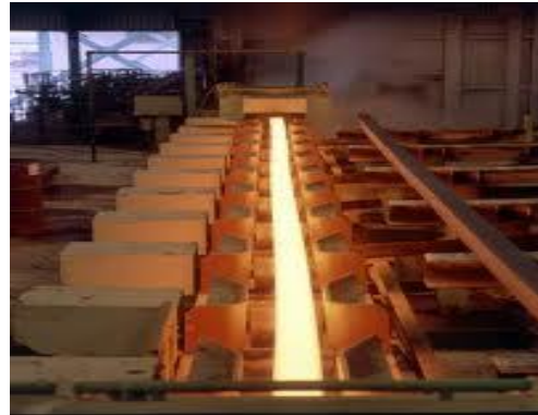
Colada para acero estructural
