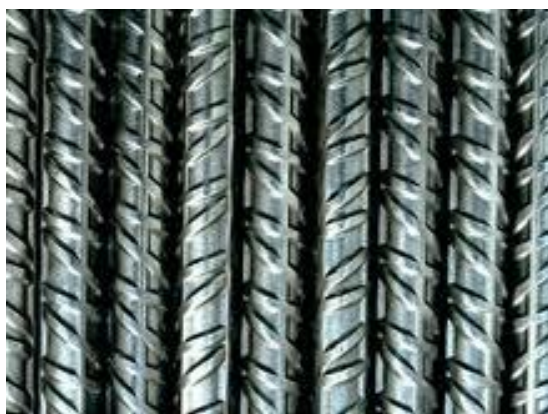
Barras corrugadas de acero B-500 S
