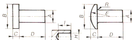
Tête cylindrique plate NF E 27-151
