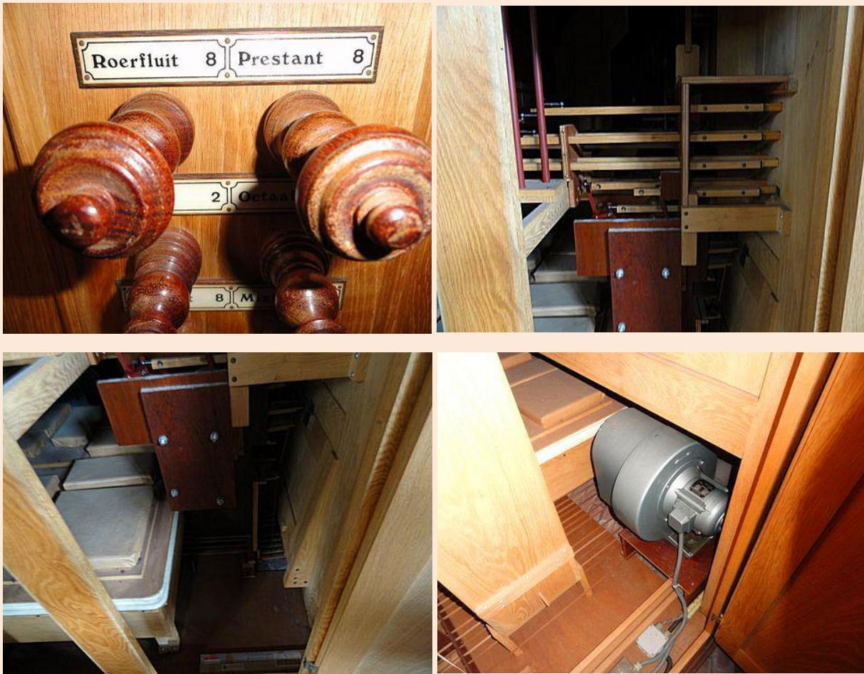
De windvoorziening bestaat uit een klassieke vouwbalg en schokbrekers. De ventilator is geleverd door de Duitse firma August Laukhuff. **The wind supply consist of bellows and floating plates, The blower is from Laukhuff (Germany).** Die Windanlage besteht au sein Ventus-Ventilator (Laukhuff), Bälge und Schwimmer.
